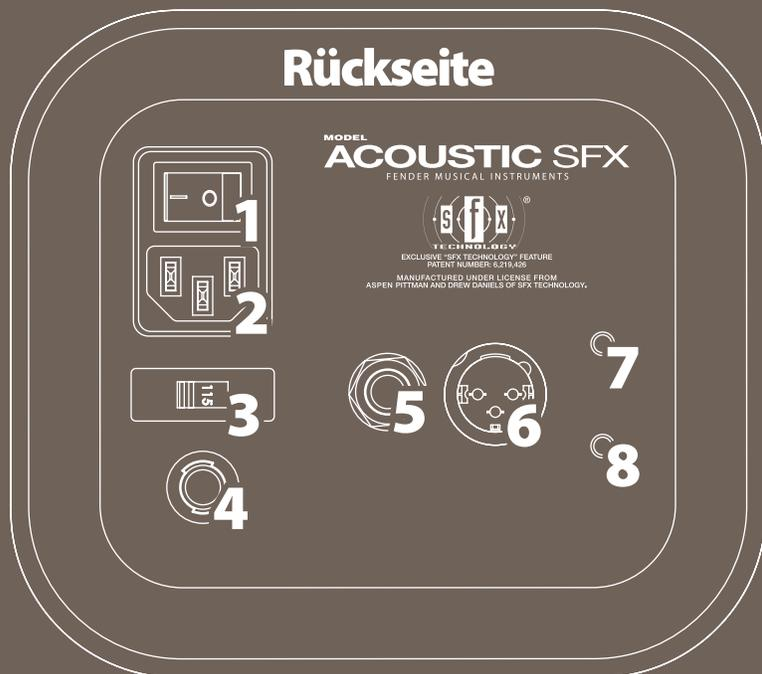
**1** NETZSCHALTER: Schaltet den Acoustic SFX® ein und aus.
